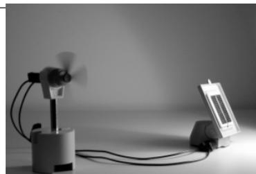
Meik vermutet, dass die **Drehzahl** des Motors von der **beleuchteten Fläche** des Moduls abhängt. Nina schlägt vor, sowohl die Auswirkungen des **Abstands** zur Lampe und als auch der Größe der beleuchteten **Fläche** zu untersuchen.
